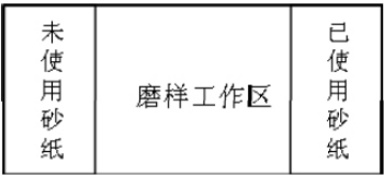
图 1 磨样工位及砂纸摆放顺序示意图
