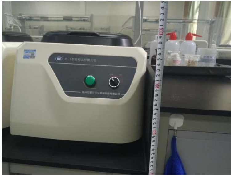
图 13 抛光工位细节：抛光机抛光盘高度约 98 cm
