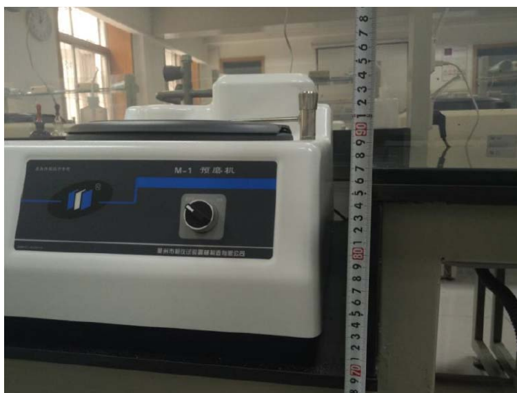
图 10 手磨、预磨工位细节图：手磨工位高度约为 87cm，预磨机磨盘高度约为 90 cm
