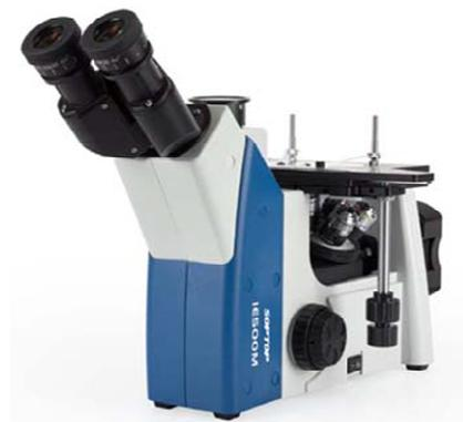
(7) 载物台：三层机械移动平台，低手位 X、Y 方向同轴调节；平台面积 180 mm × 155 mm，移动范围 76 mm × 40 mm；移动精度 0.1 mm；样品压片，可拆下；水滴型金属载物台板金属载物台板（中心孔直径 12 mm），带旋转手柄，便于 360° 旋转。
