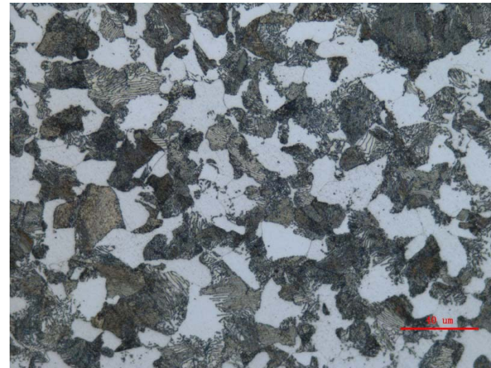
40Cr控制冷却退火试样金相图谱，500x
