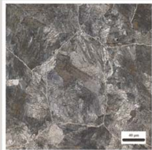
材料名称：T12钢 侵蚀剂：4%硝酸酒精溶液 显微组织：珠光体+网状渗碳体
