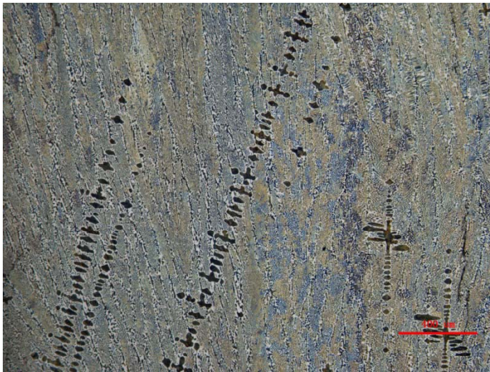
共晶白口铁铸锭 底部 样品金相图谱，50x
