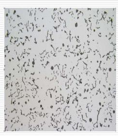
蠕墨铸铁光学显微组织照片
