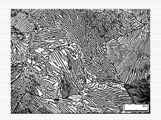
图2 珠光体的光学显微组织照片
