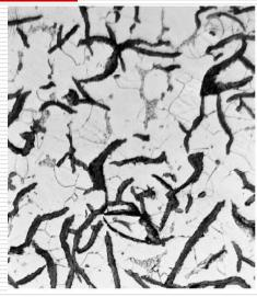
灰铸铁光学显微组织照片
