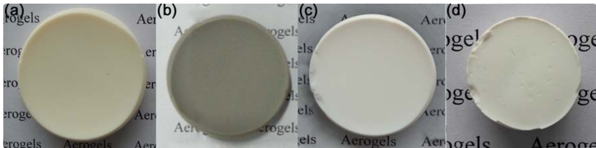
图 1 样品 AS81 经不同温度热处理 2 h 后的宏观形貌: (a) 30°C; (b) 450°C; (c) 800°C; (d) 13000°C
