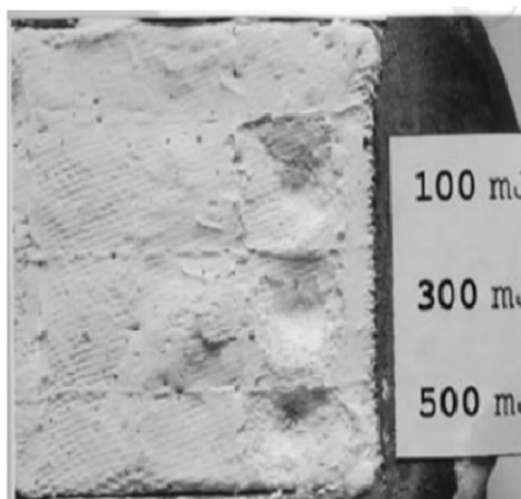
图 33 AFRSI 表面的 C-9 涂层 Figure 33 C-9 coatings on shuttle AFRSI
