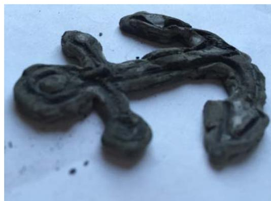
图 6 不同分层厚度情况下打印的零件
