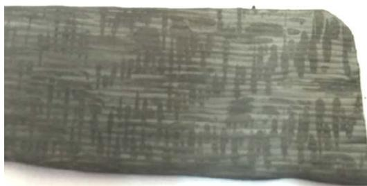
图 8 3D 打印碳化硅陶瓷坯体局部图
