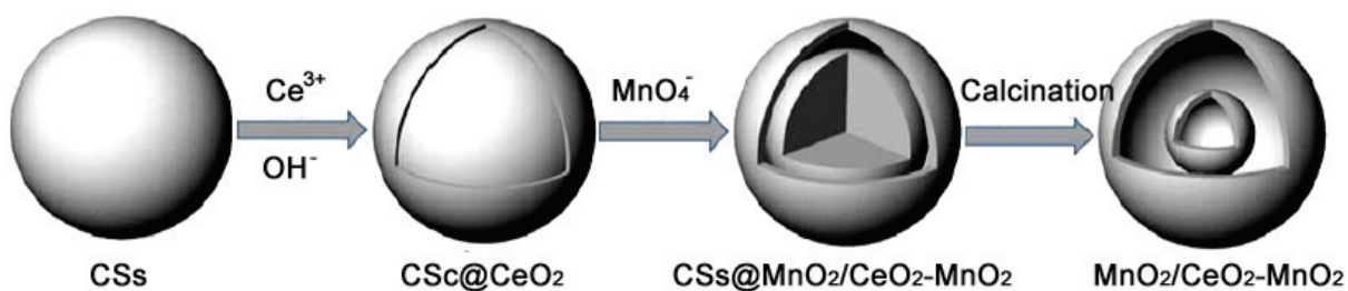
图 11 \text{MnO}_2/\text{CeO}_2\text{-MnO}_2 复合氧化物空心球的制备流程图
