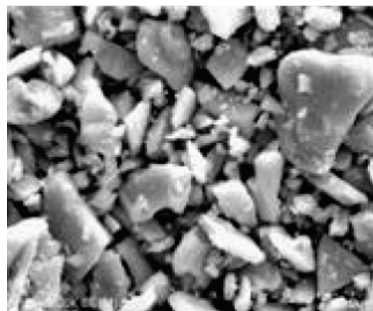
图 2 La 0.9 Sr 0.1 TiO 3 粉体的显微形貌图 (SEM) Figure 2 Micro-morphology pattern of the La 0.9 Sr 0.1 TiO 3 powder (SEM)
